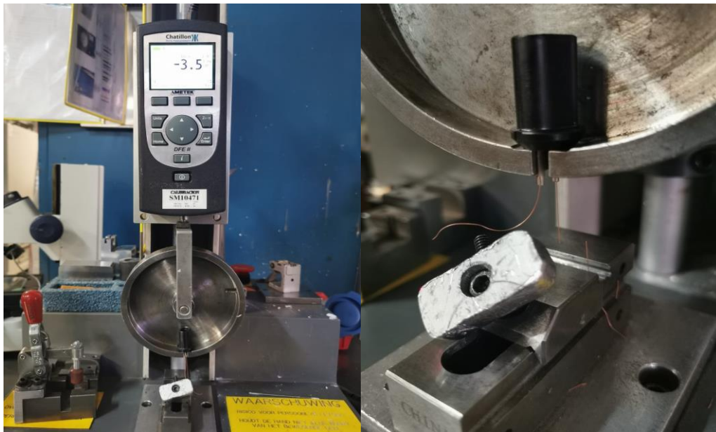
Figura 4.4 Prueba de desprendimiento de soldadura
